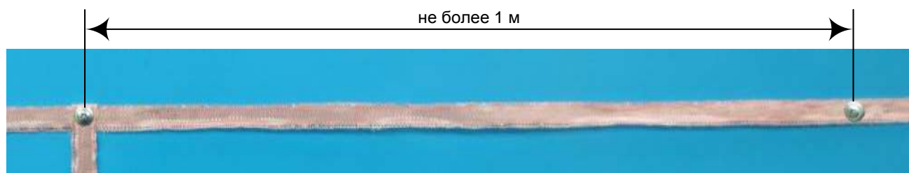
Рис. 13. Прокладка ленты основания.
