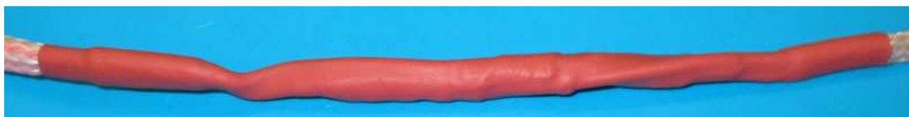
Рис. 29. Место наращивания кабеля.
