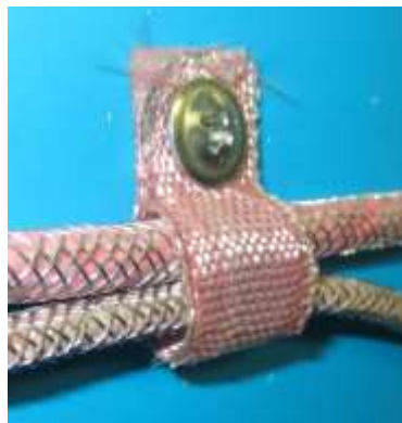
Рис. 5. Установка дюбель–хомута КФСТ.735322.041 и КФСТ.735322.164. Вариант 1.
