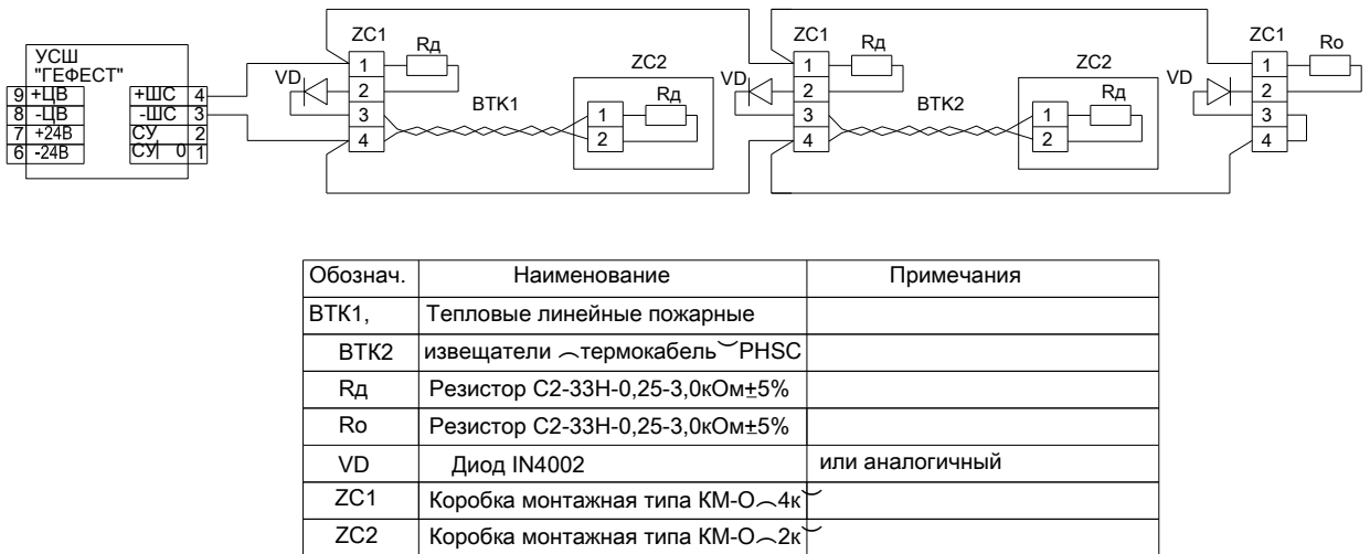
Рис. 3 Схема включения в шлейф линейных тепловых извещателей — термокабеля — типа PHSC
